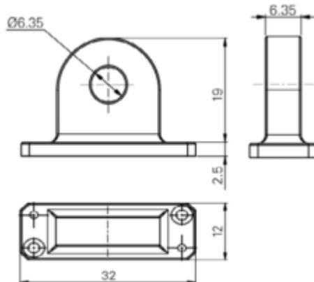
**Produktbeschreibung****1334 101:** Abhebevorrichtung für Messweg 12,5mm**1334 102:** Abhebevorrichtung für Messweg 25mm**1334 201:** Rückendeckel mit Öse**Lieferung einzeln verpackt****Technische Daten****Größe:** für/for 1301 1..**Artikel-Nr.:** 1334201**Marke:** SYLVAC**Herstellernummer:** 805.0213**Typ:** Rückendeckel Öse**Gewicht:** 0,01kg
