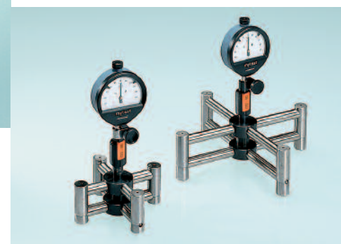
Kufen-Kreuzhülse für \varnothing 130 - 800 mm für tiefe Bohrungen bzw. Durchgangsbohrungen, die Ausrichtung des Messgerätes in der Bohrung erfolgt durch 4 Kufen
