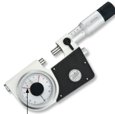
Toleranzmarken einstellbar Tolerance marks adjustable
